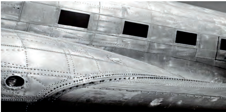
Eerste vliegtuigen gemaakt van aluminium legeringen (let op de bolkop klinknagels, de kleine nagelafstanden, de rechthoekige ramen, en het ongelijke oppervlak).
