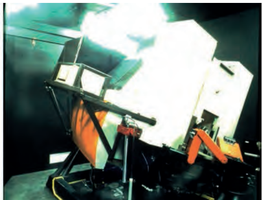
Doorsnede van TUD 3-DOF vlucht simulator met Fokker F27 cockpit (1969).
