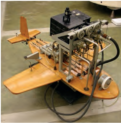
Sperry A3 onderwijsmodel voor automatische standregeling van een vliegtuig (TU Delft, ca. 1960).
