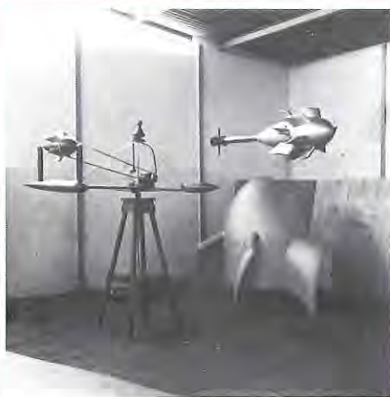
Links: het eerste model, met enkele krans en naaimachinemotor. Rechts boven: het tweede model met dubbele krans. Rechtsonder: de eerste enkele Dekkerpropellor.
