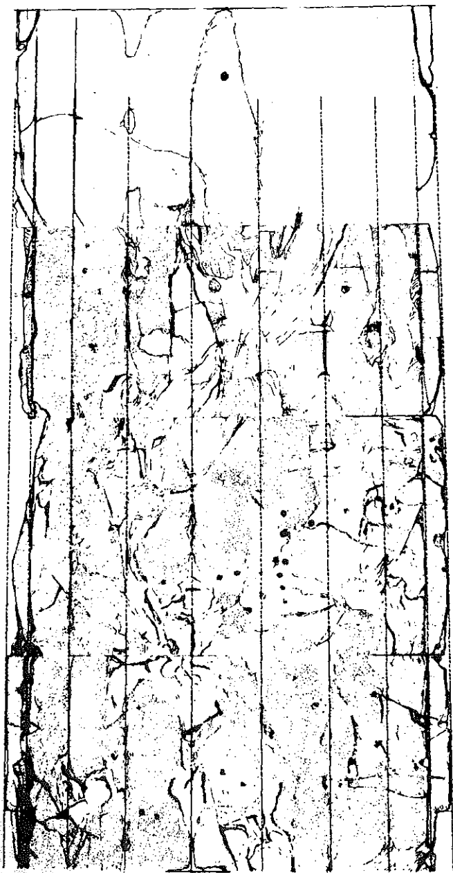
Detailtekening van de schade aan het oppervlak van vier zuiltrommels. Met name de kogelgaten (van de Vrijheidsoorlog?) zijn goed te herkennen.
